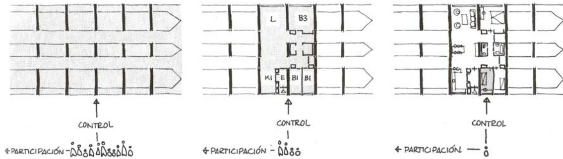
Figura 2: Mecanismos de control sobre el sistema de ‘Soportes y unidades separables’.
